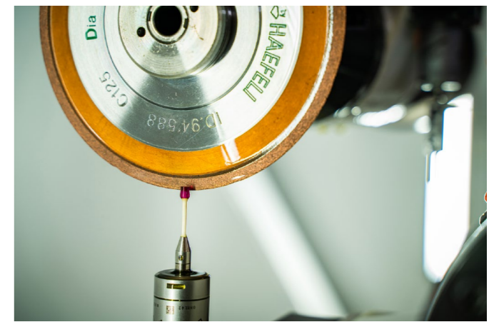
Erweiterte NUMROTO Funktion: Scheibentastaster
